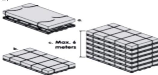
Die Lagerung der Platten sollte waagrecht zum Untergrund erfolgen. Die Platten sollten ordentlich übereinanderliegen. Der maximale Stützabstand der Unterleghölzer liegt bei 600mm. Achten Sie auf einen angemessenen Kantenschutz, um Beschädigungen vorzubeugen.
