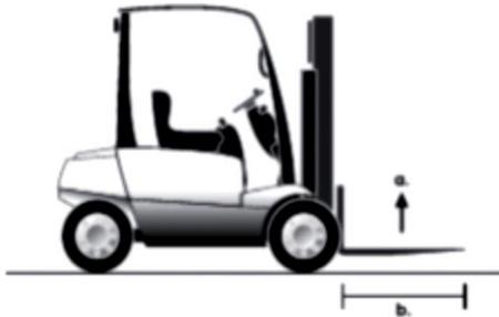
Kompaktplatten sind schwer. Stellen Sie sicher, dass Sie einen geeigneten Gabelstapler nutzen und die Gabellänge der Palettengröße angepasst ist. Überladen Sie den Gabelstapler in keinem Fall.
