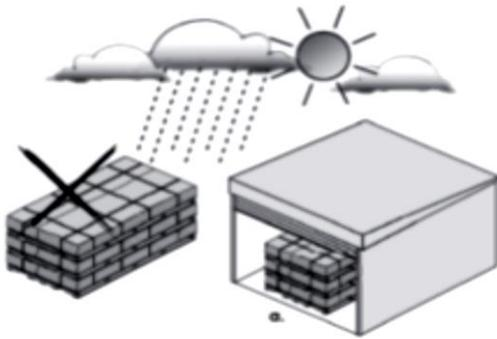
Lagern Sie die HPL Kompaktplatten in einem trockenen und überdachten Bereich. Lagern Sie die Kompaktplatten nicht im Regen oder direkter Sonneneinstrahlung.
