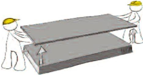
Die Kompaktplatten sollten manuell mit mindestens zwei Personen manipuliert werden. Alternativ sind auch maschinelle Vorrichtungen wie z. B. Vakuum-Lifter üblich. Bewegen Sie die Platten vorsichtig. Achten Sie darauf, die Platten nicht übereinander herzuschieben.
