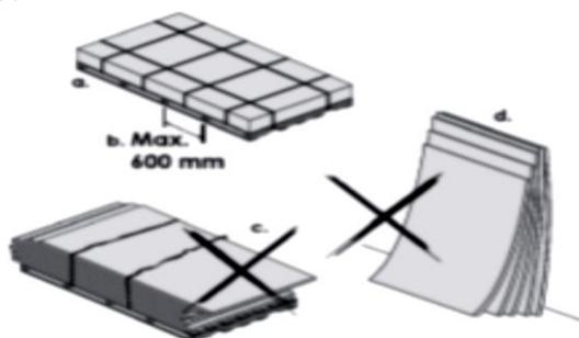
Stellen Sie die Platten nicht vertikal an eine Wand o. Ä. Achten Sie darauf, dass zwischen den einzelnen Platten keine Hohlräume entstehen, in der sich die Platten hineinbiegen könnten.
